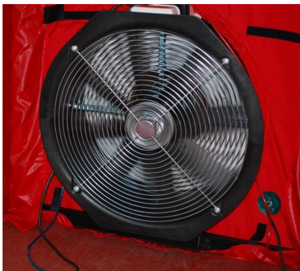
Obr. č. 7: Detail kalibrovaného ventilátoru aparatury Blower Door Testu Minneapolis no. 4
